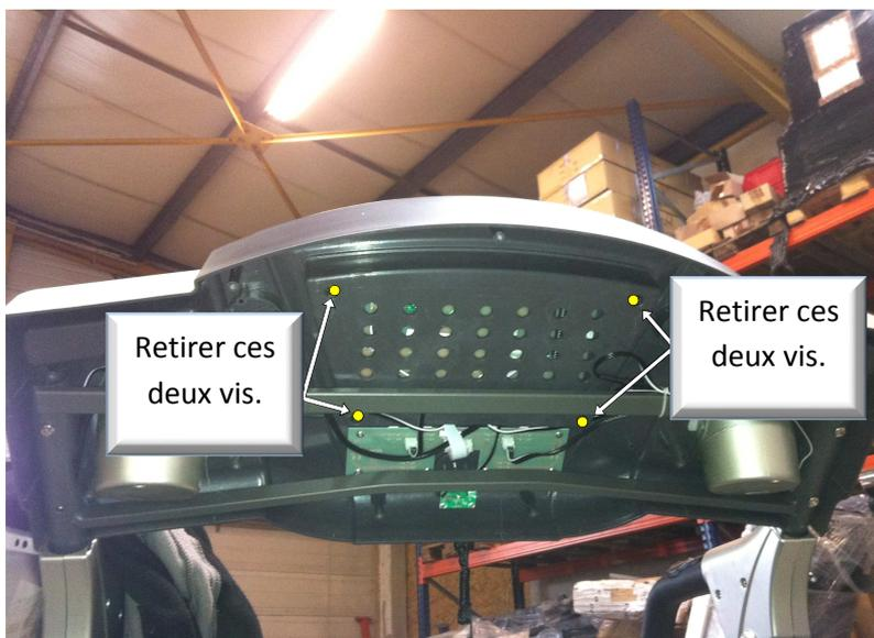
ETAPE 3 : Repérage des connectiques électrique a débranché
