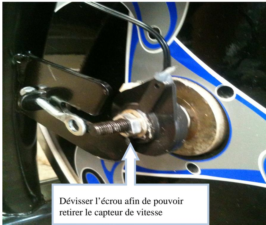
ETAPE N°5 : - Extraire le capteur de vitesse HS et le remplacer par le nouveau.
