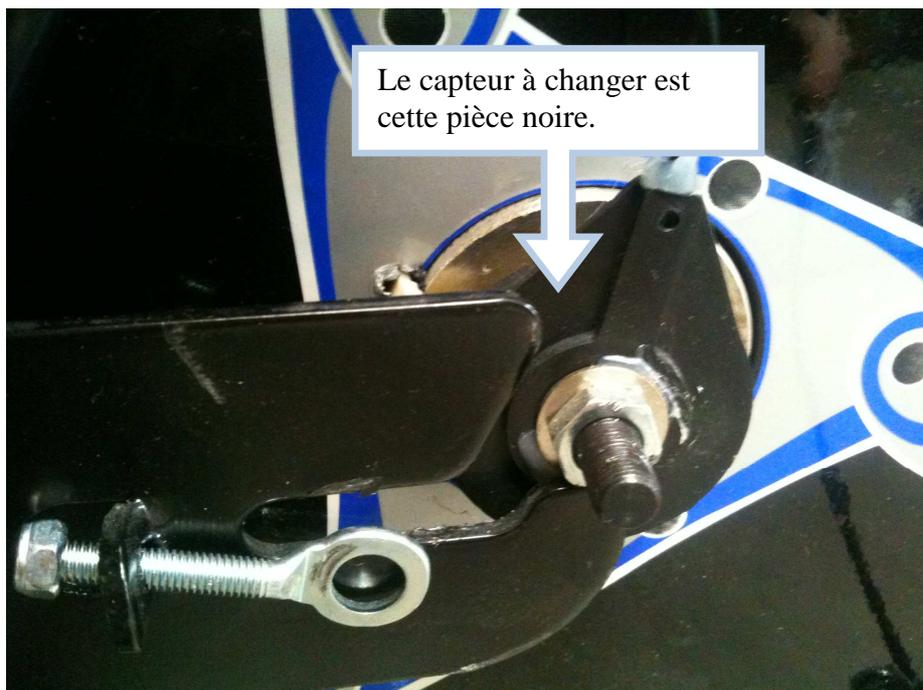
Voici une photo de la roue sans écrou de fixation.
