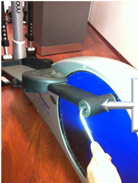
A l'aide d'une clef, démonter la vis du repose-pied arrière.
